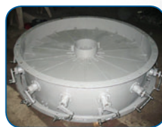
Modernizacje układów kierowniczych wentylatorów promieniowych
