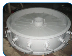
Modernizacje układów kierowniczych wentylatorów promieniowych
